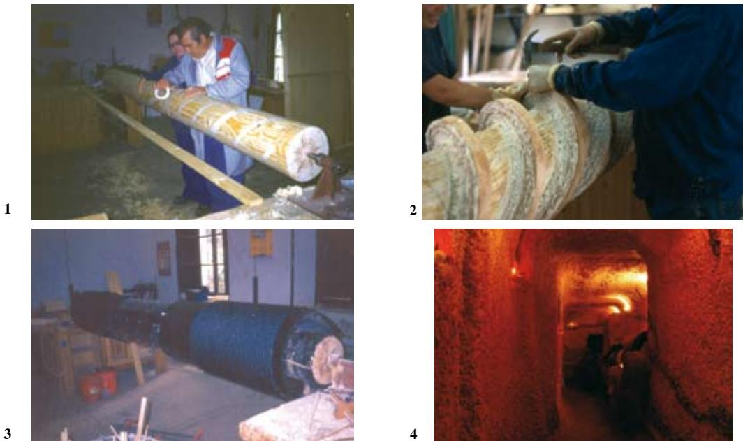
Tornillos de Arquímedes reproducidos a escala 1/1 con medidas reales tomadas de Vitrubio. Proceso de construcción
