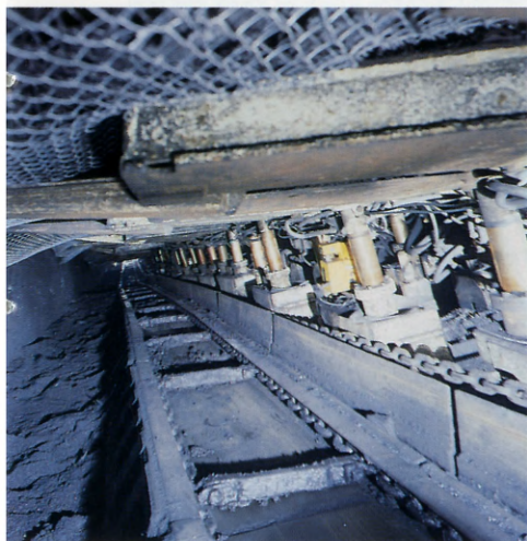
En la nueva mina, los páncores estarán dotados de motores hidráulicos.
